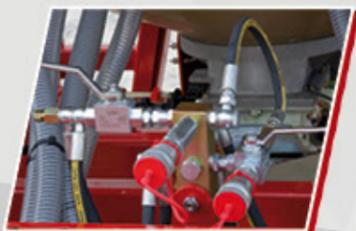
Toma hidráulica para sinfín y mecanismo de seguridad en el transporte.
