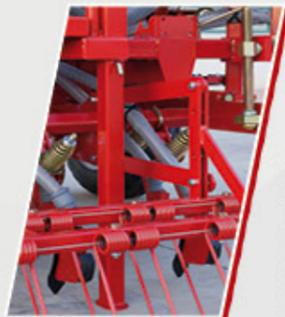
Pie de apoyo trasero para poder enganchar la sembradora al tractor fácilmente.
