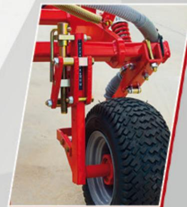
La regulación de la profundidad de las extensiones se consigue mediante el ajuste de su rueda de apoyo. Extensiones flotantes durante la siembra para adaptarse al terreno en sentido transversal.
