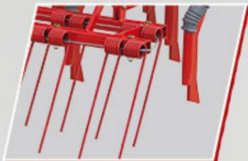
Grada de tapado montada sobre paralelogramo con dos filas de dientes rectos. Cable de acero anti-pérdidas.
