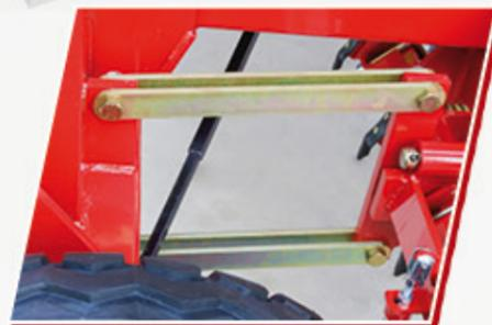
El tren de siembra es totalmente independiente del chasis principal gracias a un **paralelogramo** que permite que la sembradora copie las irregularidades del terreno en el sentido de marcha del tractor para conseguir una profundidad de siembra homogénea.
