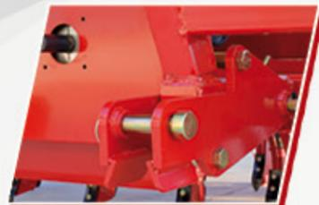
Enganche flotante a las barras del tractor para mejorar la adaptación de la sembradora al terreno en el sentido de marcha del tractor.
