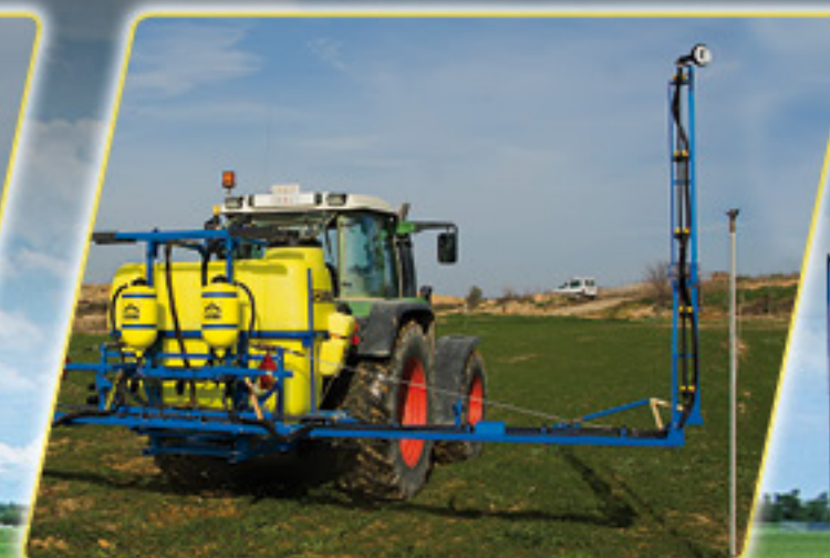
Pliegue de barra progresivo que permite trabajar con el resto de la barra cuando superamos un obstáculo.
