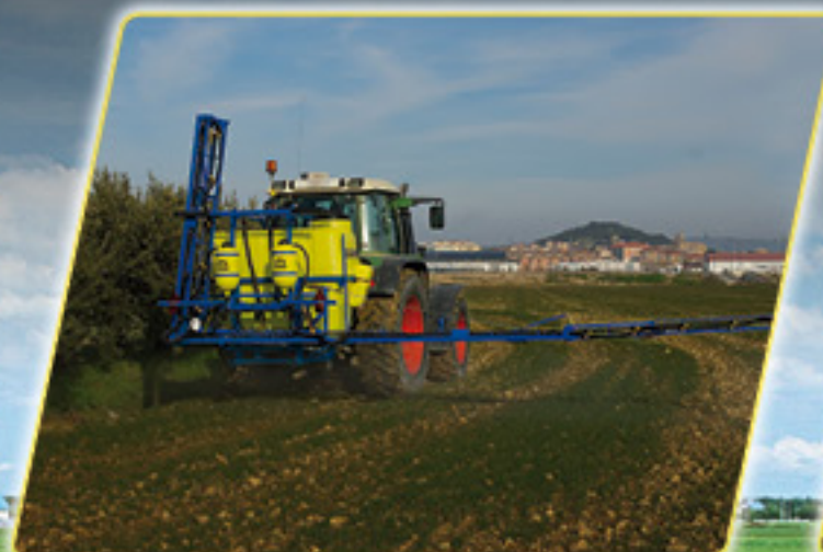
Sistema automático de bloqueo de media barra para trabajar hacia el interior de las parcelas.
