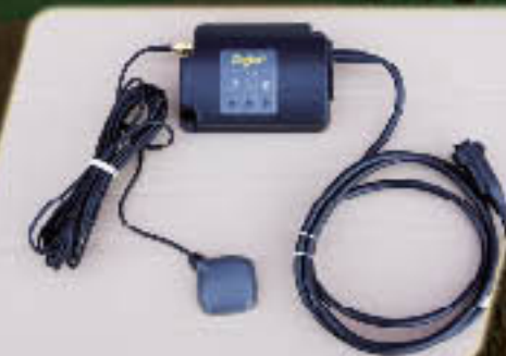
Antena GPS para informar al sistema de la velocidad de avance
