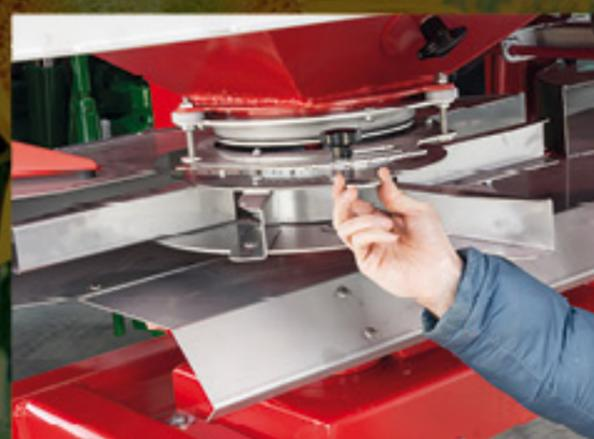
Su diseño específico permite que el fertilizante se incorpore al disco esparcidor lateralmente; de este modo entran en las paletas de forma suave y sin impactos, evitando roturas de granos y generación de polvo.
