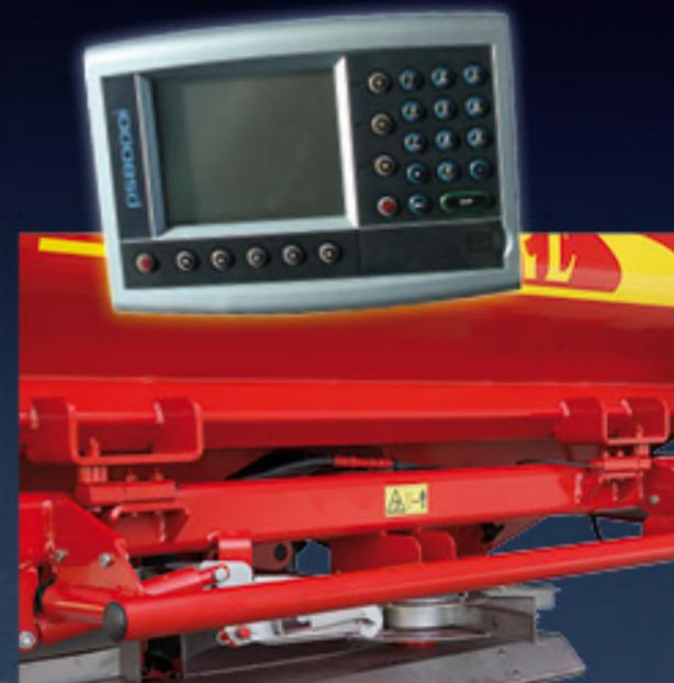
④ El dispositivo **APOLLO** (DPAE) con sistema de pesaje en continuo nos permite distribuir la dosis deseada de cualquier fertilizante sin necesidad de calibración previa.
